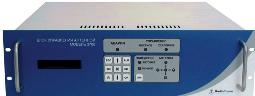
Рисунок 1.2.2.1 - Внешний вид лицевой панели БУА 3700
